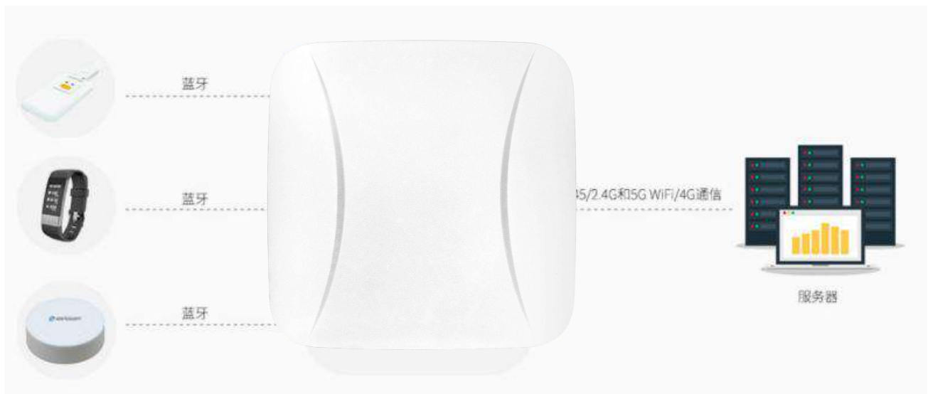
图 1-4 蓝牙网关采集蓝牙信标信号强度
