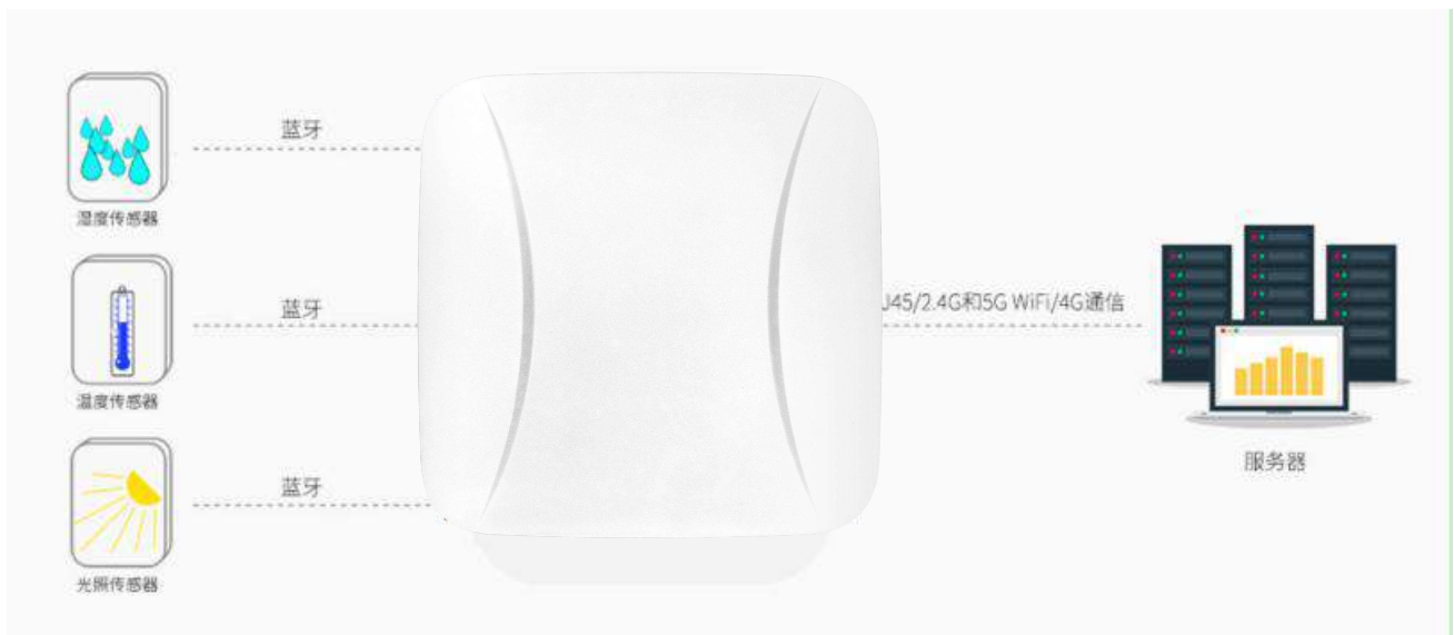
图 1-3 蓝牙网关采集蓝牙传感器信息
