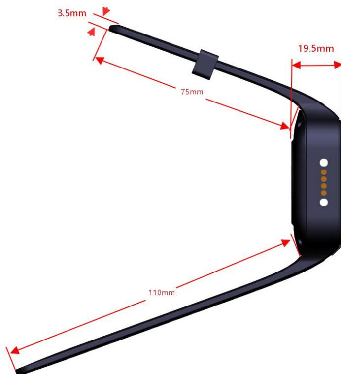
图 4-2 VDB1610 侧面尺寸 (±1mm)
