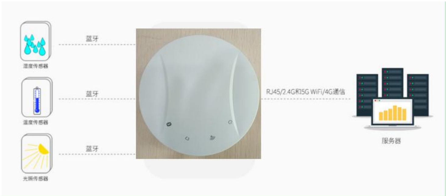
图 1.5.1 蓝牙网关采集蓝牙传感器信息
