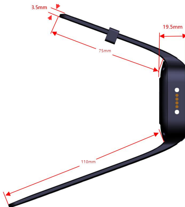
图 5-2 VDU1502A 表带尺寸 (±1mm) /VDU1502A band size (±1mm)
