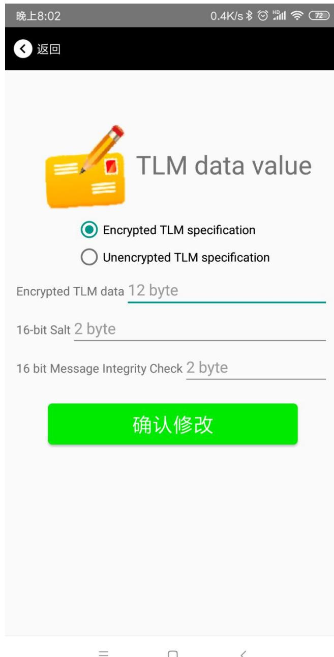
推荐选择 Encrypted TLM specification (加密的 TLM 规范)，然后输入分别输入最多 12 字节的 Encrypted TLM data (加密 TLM 数据)，2 字节的 16-bit Salt，以及 2 字节的 16 bit Message Integrity Check.
